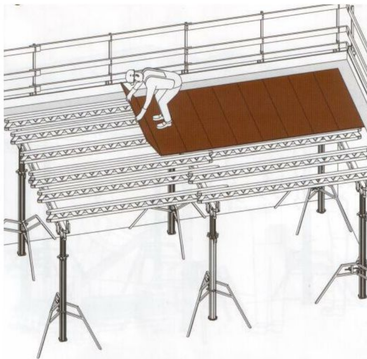
Рис.20. Укладка листов фанеры
