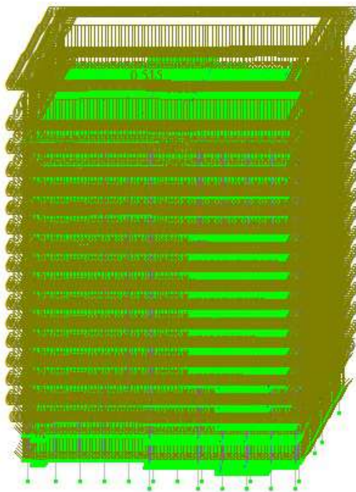
Рис. 2. Собственный вес наружных стен
