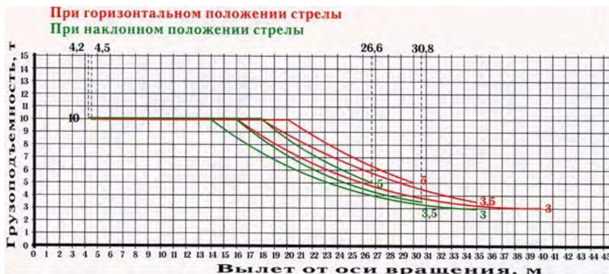
Рисунок 4.5 – График грузоподъёмности крана КБ-408.21
