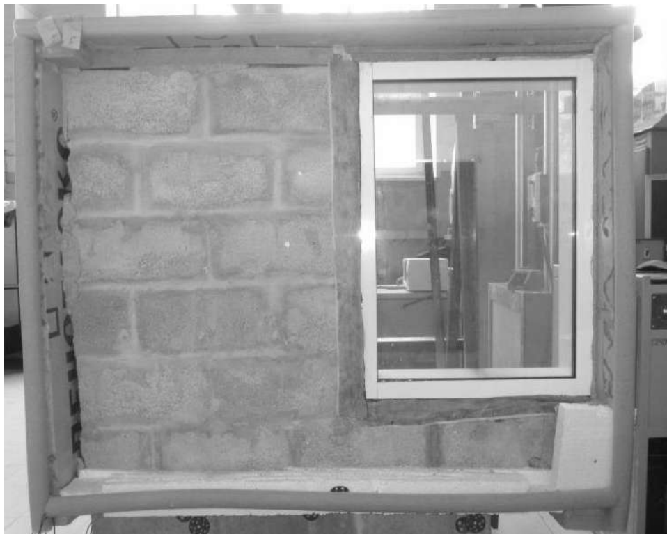
Рисунок 3.1.1.2 Исследуемый фрагмент без утепления и дефектов
