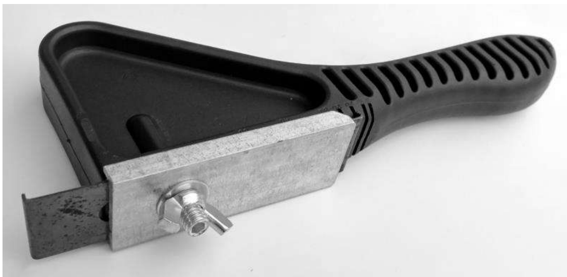
Рисунок А.1 Капотосъемник для фасадного остекления
