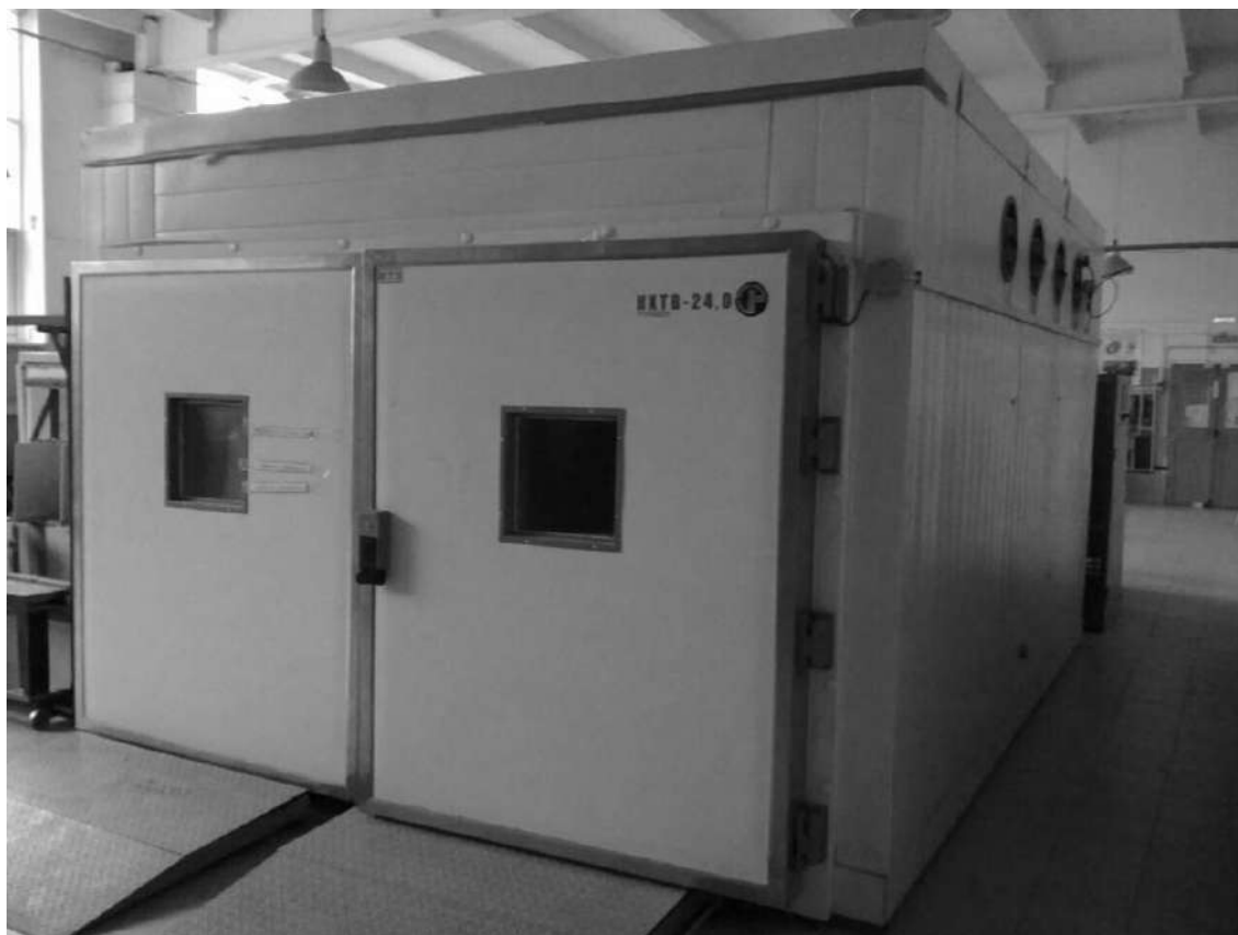
Рисунок 2.2 Климатическая камера КХТВ-24,0
