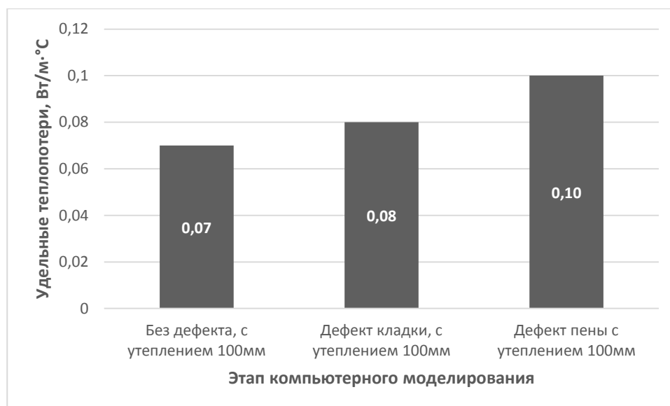
Рисунок 3.2.13.3 Сравнительный график влияния дефектов линейных элементов оконной конструкции на удельные теплотери при теплоизоляции фасада утеплителем экструдированный пенополистирол Экстрол 100 мм
