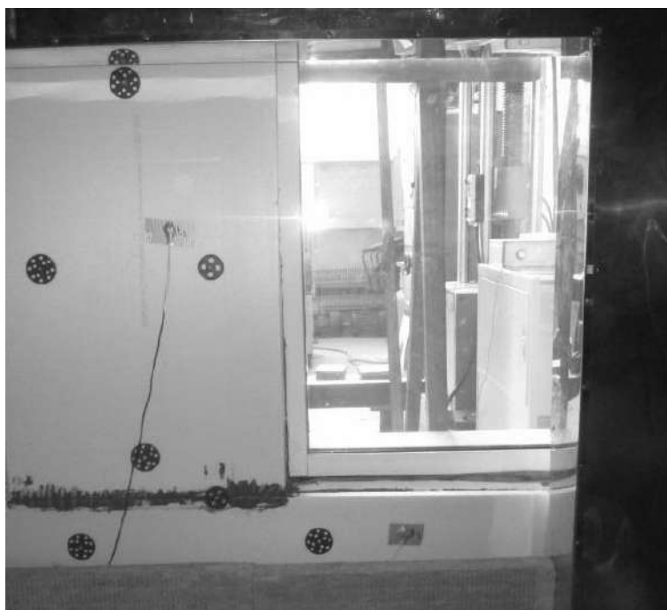
Рисунок 3.1.3.2 Исследуемый фрагмент с утеплением 100 мм без дефектов
