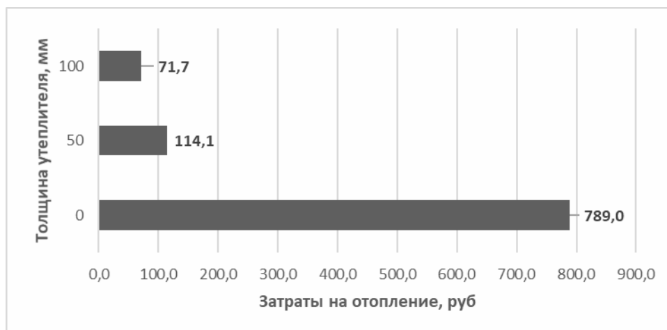
Рисунок 4.1.1.4 Затраты за год на отопление энергии, потерянной зданием при дефектах кладки в области оконных откосов (дефектность 25%, утеплитель - минплита).
