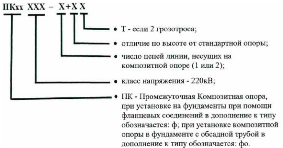
Рис. 3.2. Расшифровка условного обозначения типа композитной опоры.
