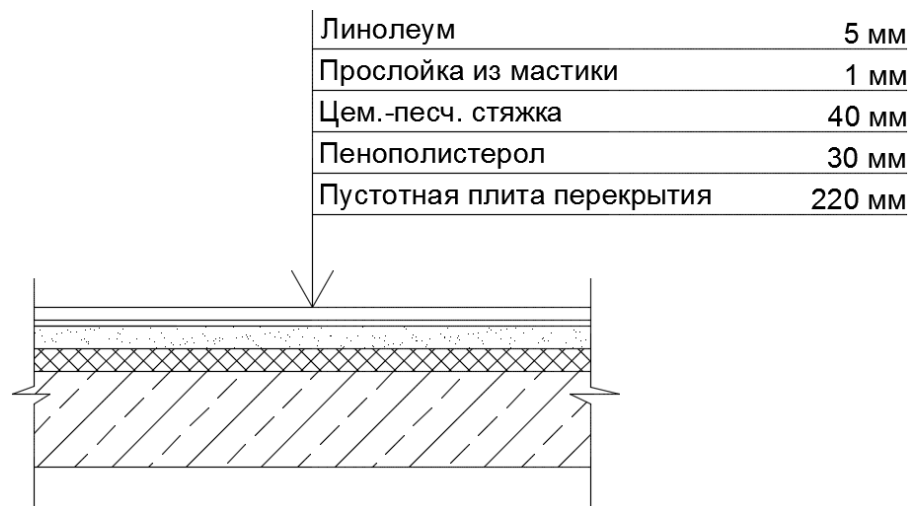
Рисунок 2.1.2.1. Конструкция покрытия
