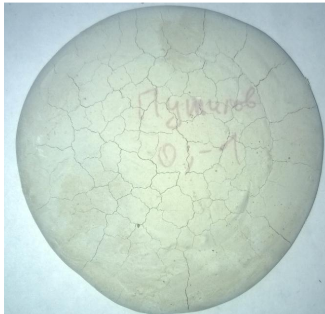
Рисунок 3.14 – Результат испытания на равномерность изменения объема для плотности раствора 1,2 \text{ г/см}^3 , НГ
