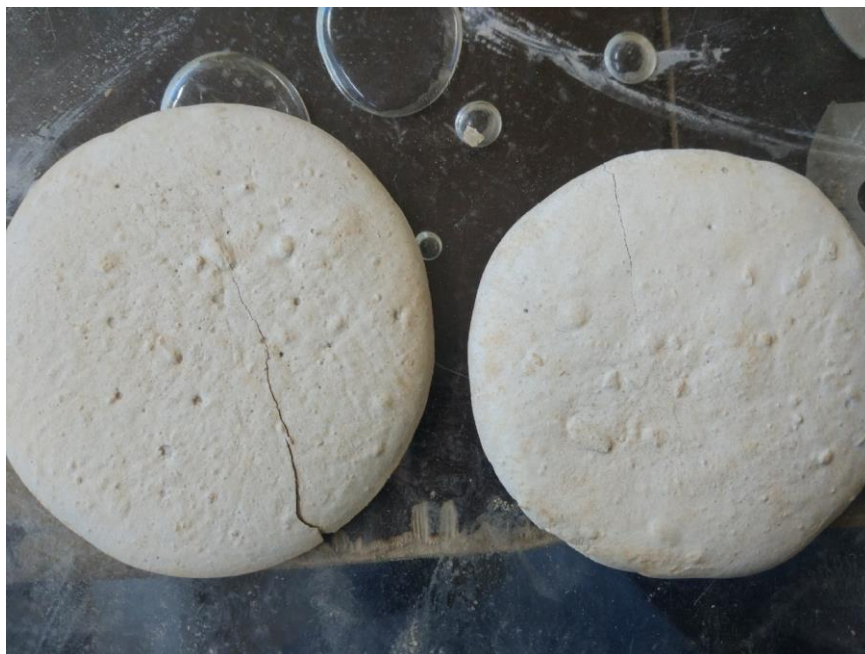
Рис. 3.1 Образцы лепешки из исходного вяжущего при плотности затворителя 1,2 г/см 3
