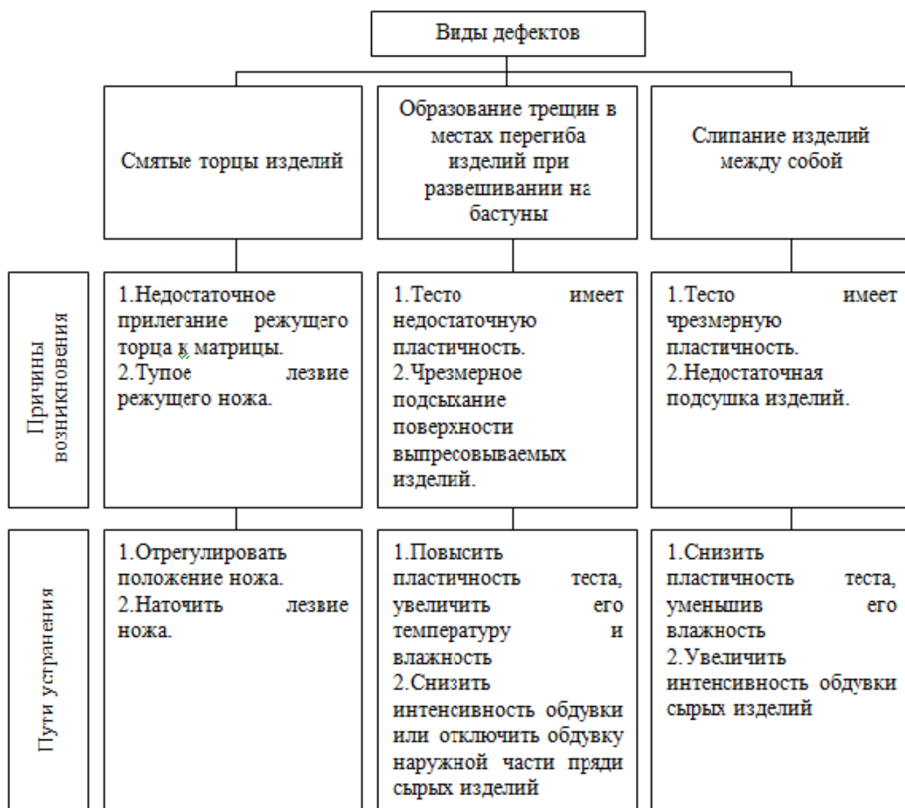
Рисунок 1.4 – Дефекты, возникающие при производстве макаронных изделий, и пути их устранения
