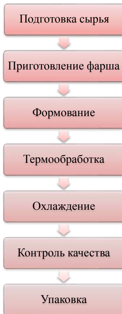
Рисунок 3– Технологическая схема производства колбасных изделий.
