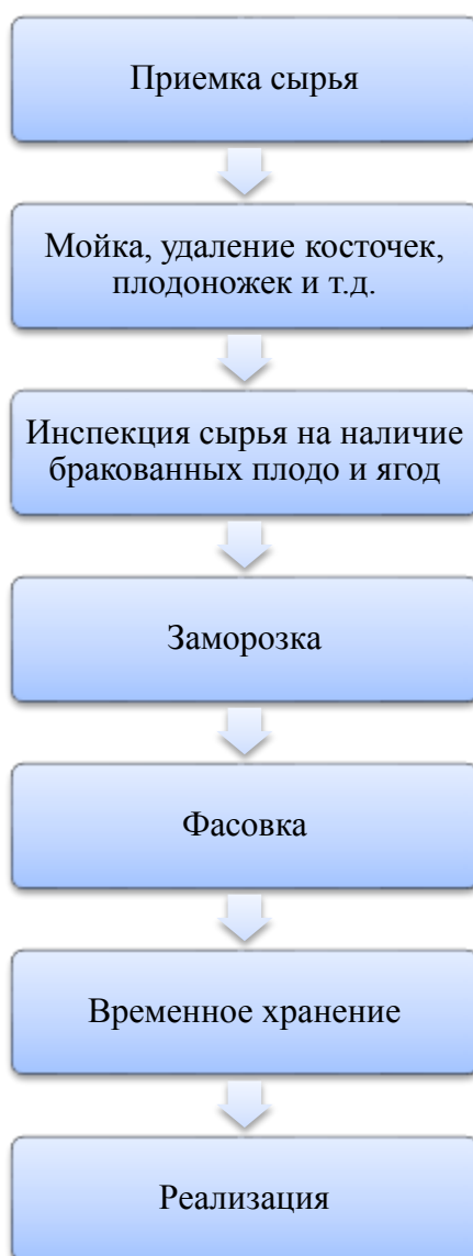
Рисунок 2 – Схема производства быстрозамороженной продукции
