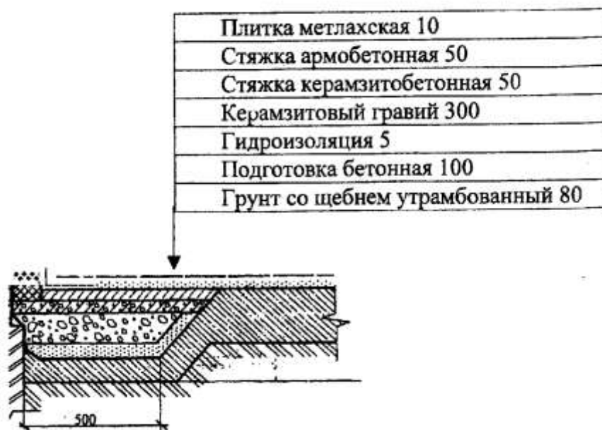
Рисунок 8 – Устройство теплоизоляции пола и теплоизоляционной отсыпки вдоль стен с температурными режимами выше 0 °С
