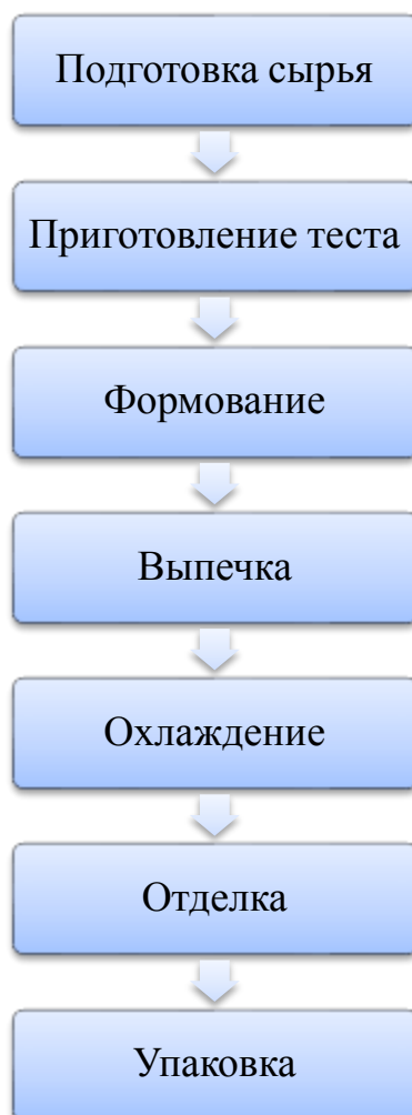
Рисунок 3 – Схема производства кексов
