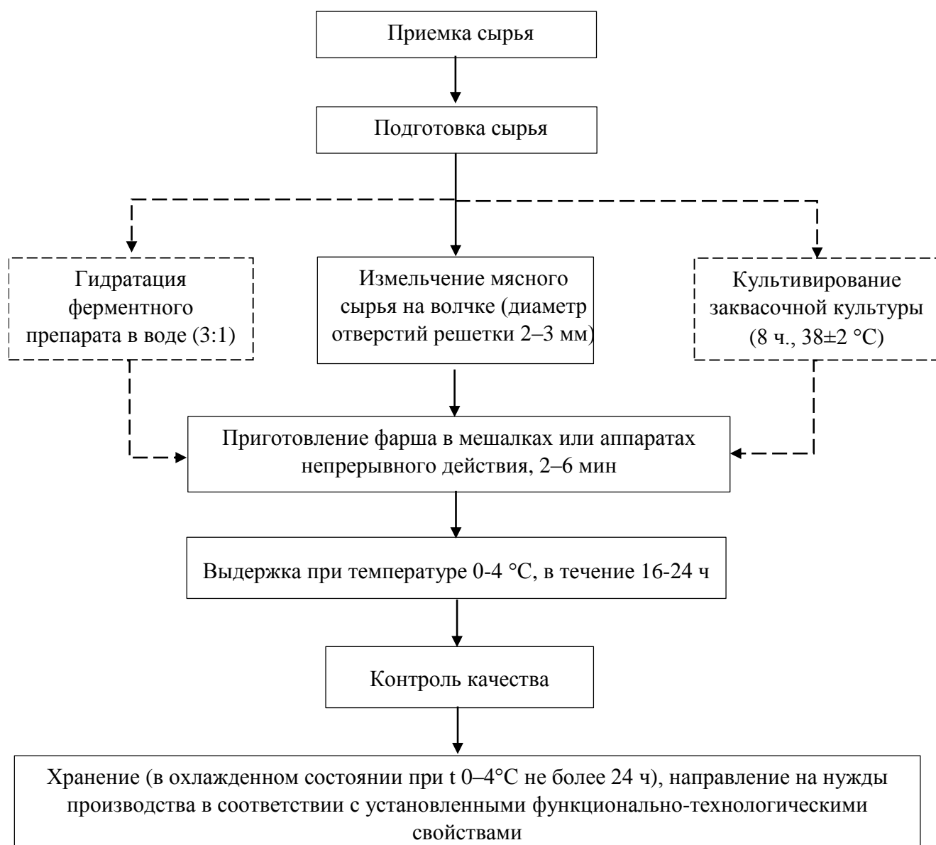
Рисунок 14 – Технологическая схема производства биотехнологически обработанных мясных фаршей
