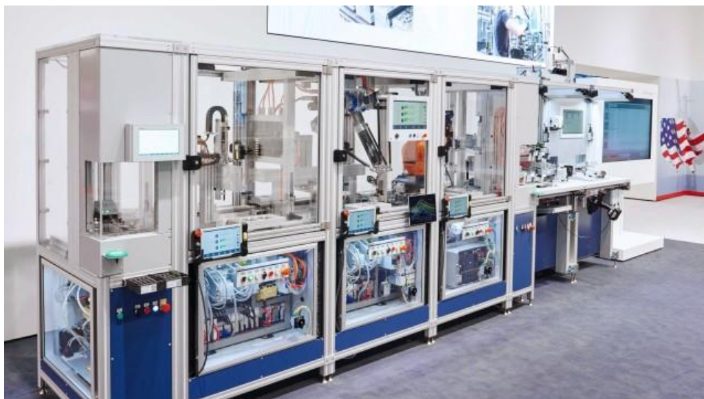
Рисунок 1 – Блоки управления станками собраны в модули производственной линии, на примере Bosch
