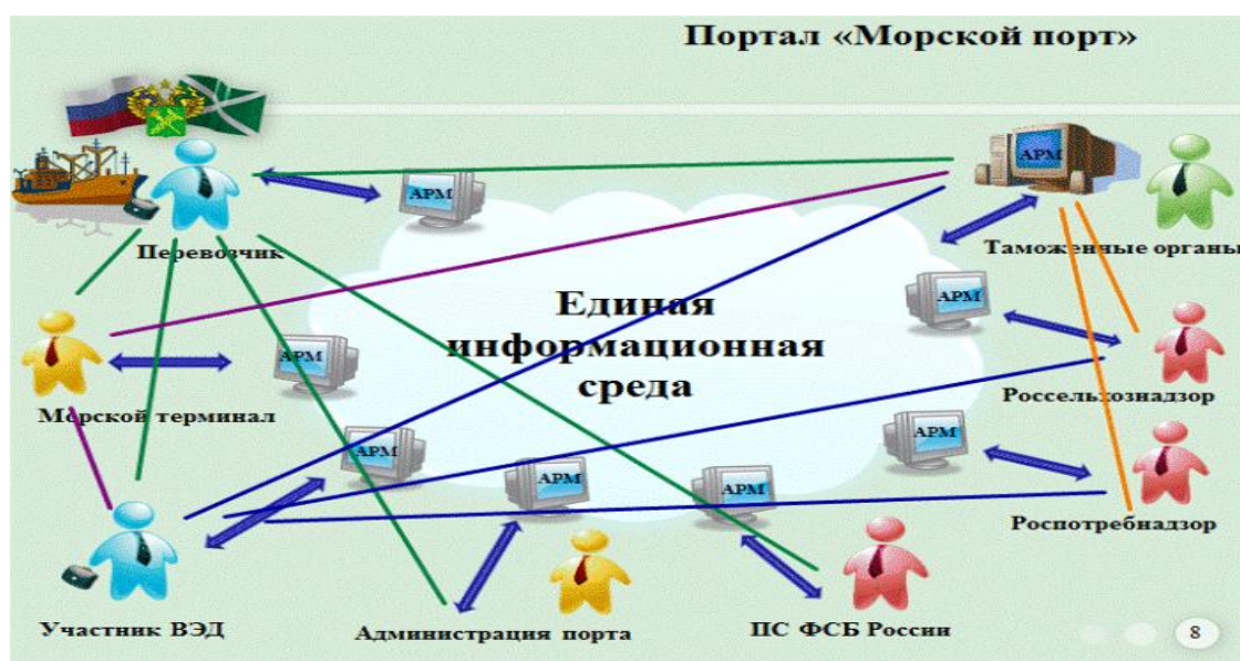
Рисунок 18 – Схема информационного обмена посредством портала «Морской порт»
