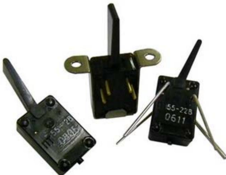
Рисунок 3.11 – Внешний вид тумблера ПТ55
