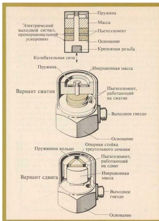
Рисунок 3 – Строение акселерометров подвергаемых действию сжатия и сдвига
