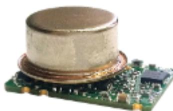
Рисунок 2.4 — Кварцевый генератор
