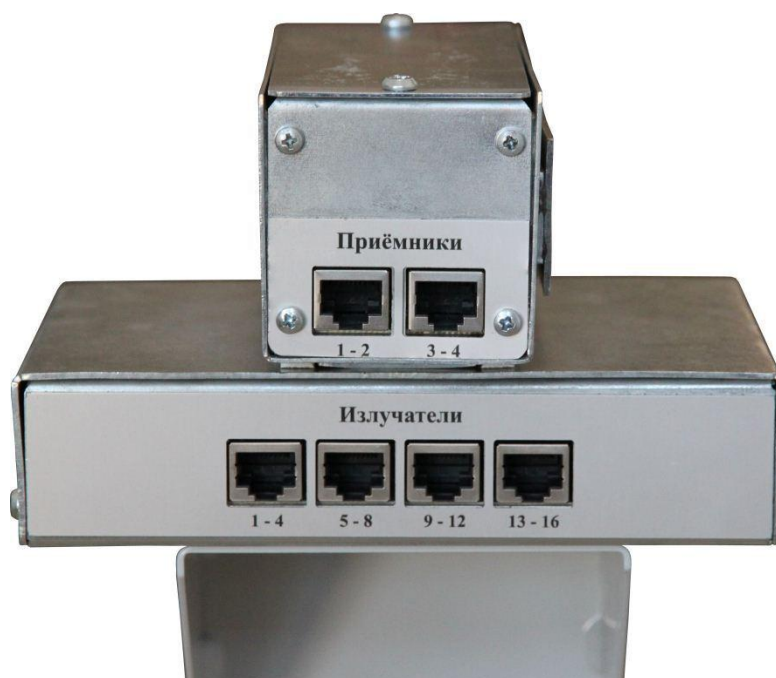
Рисунок 3.3 – Вид антенного блока со стороны разъемов
