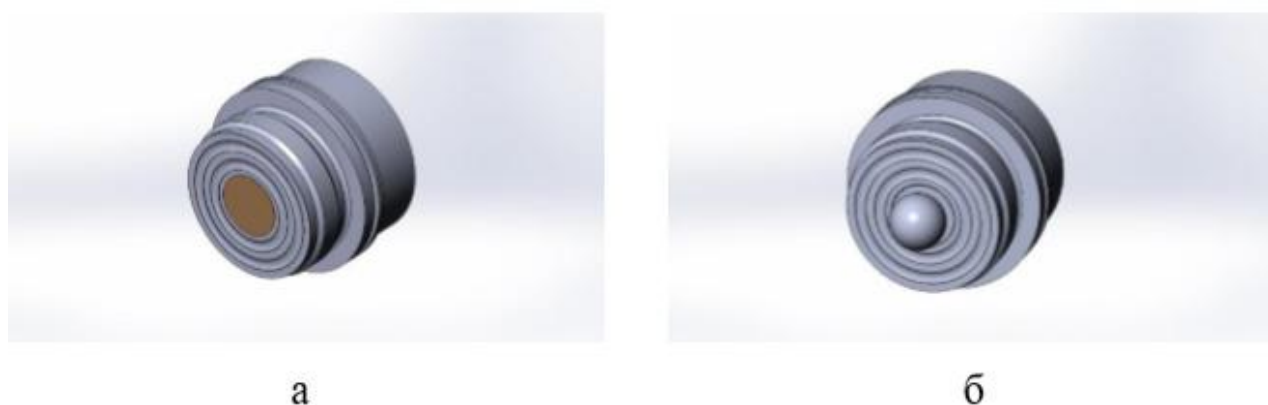
Рисунок 3.2.1 - Конструкция преобразователя с дополнительным слоем (а) и с дополнительным телом шарообразной формы (б) на разделительной мембране
