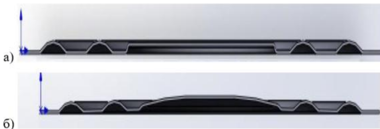
Рисунок 3.3.1 - Нормальная (а) и деформированная (б) разделительная мембрана
