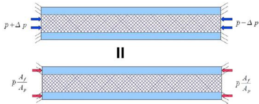
Рисунок 14 – Влияние давления эквивалентно осевому напряжению (сжатию) для тонкой трубки с протекающей жидкостью
