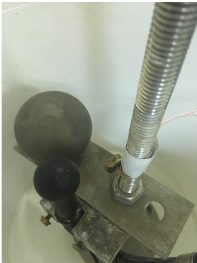
Рисунок 4.1 – Установка для нахождения АЧХ кольца
