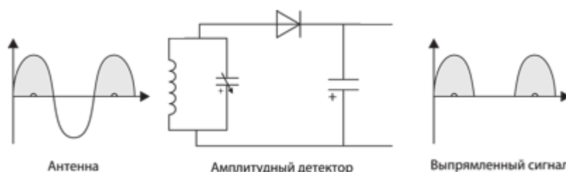
Рисунок 13 – Схема полуволнового выпрямителя
