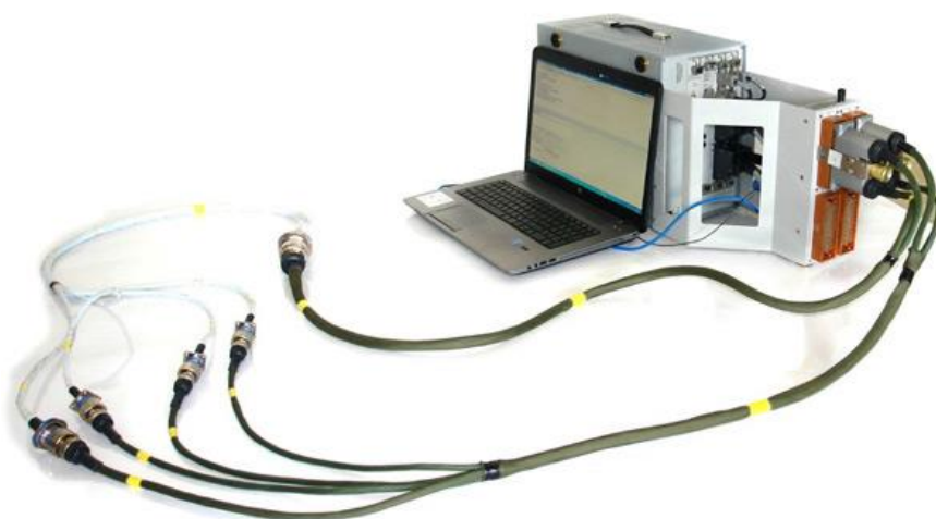
Рисунок 15 – Устройство для тестирования кабельных сборок в условиях эксплуатации
