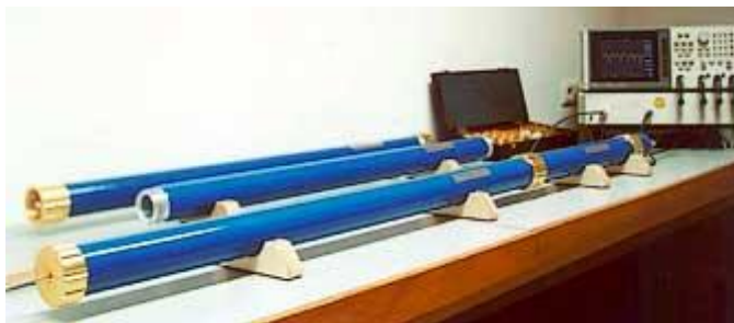
Рисунок 5 – Измерительный комплекс для измерения затухания экранирования кабелей и кабельных сборок
