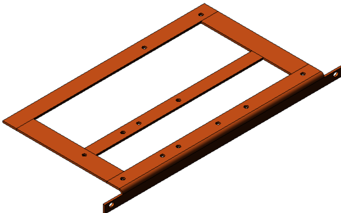
Рисунок 19 – Кассета для крепления печатных узлов, предназначенных для передачи измеренных значений тока
