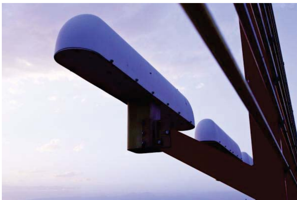
Рисунок 4 – Излучающий элемент антенны курсового радиомаяка системы посадки Thales ILS-410
