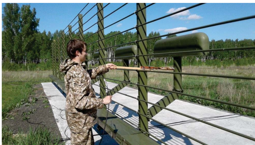
Рисунок 9.1 – Измерения АФР в антенне КРМ на полигоне
