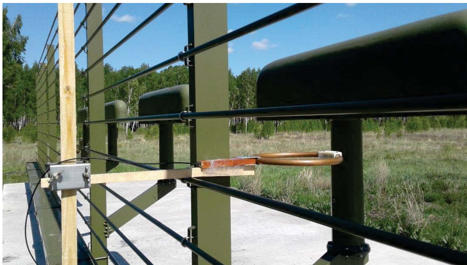
Рисунок 9.3 – Реализация голографического метода измерения АФР антенны КРМ
