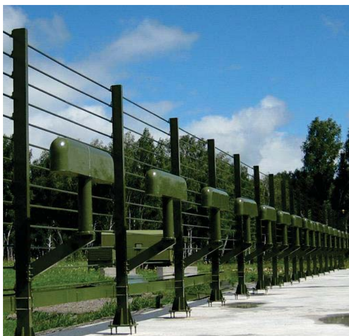
Рисунок 1 – Антенна курсового радиомаяка метровой системы посадки СП-2010
