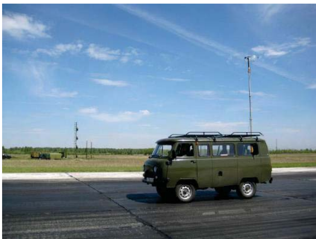
Рисунок 4.1 – Мобильный стенд для наземных исследований курсового радиомаяка
