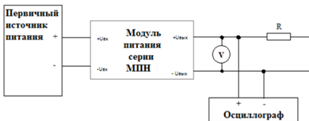
Рисунок 11 – Подключение объекта контроля
