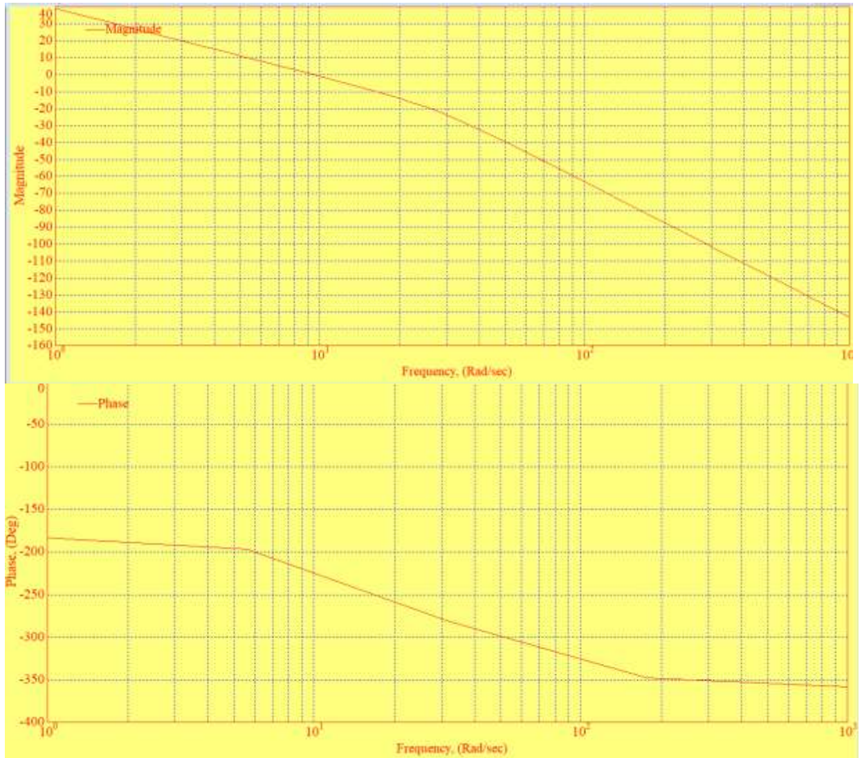
Рисунок 3.10 – Графики ЛАХ и ФЧХ разомкнутой системы второго канала
