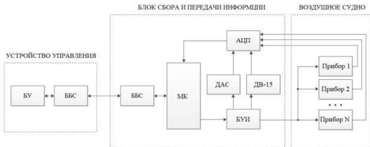
Рисунок 18 - Структурная схема комплекса «ДАМП»:
