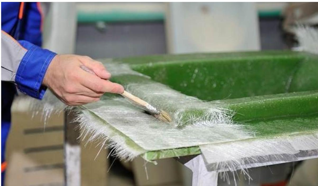
**Рис.1.** Изготовление композитного материала для лодок
