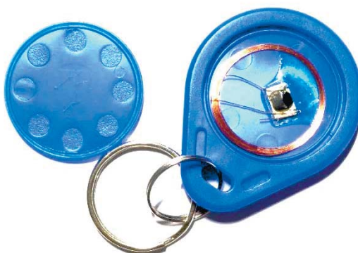
Рисунок 4.1.4 – Антенна брелка Mifare
