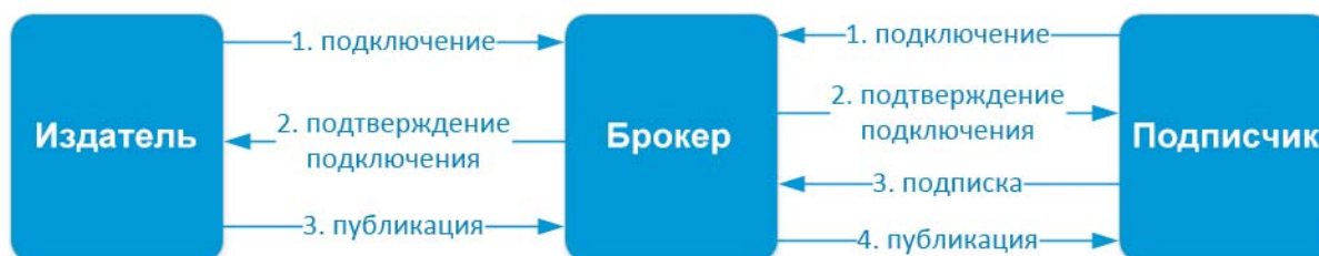
Рисунок 4 – Взаимодействие клиентов с брокером в MQTT протоколе
