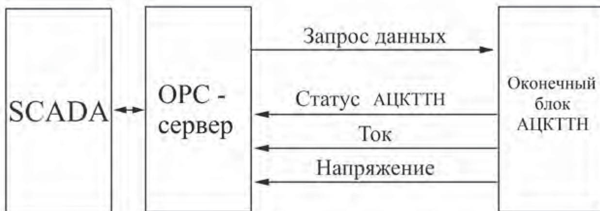
Рисунок 3 — Схема взаимодействия АЦКТТН с АСУ ТП
