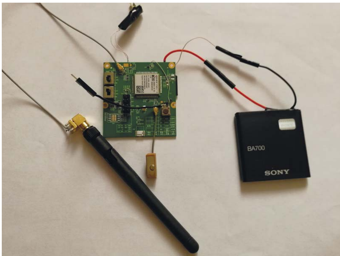
Рисунок 4.2 – Макетный образец трекера.
