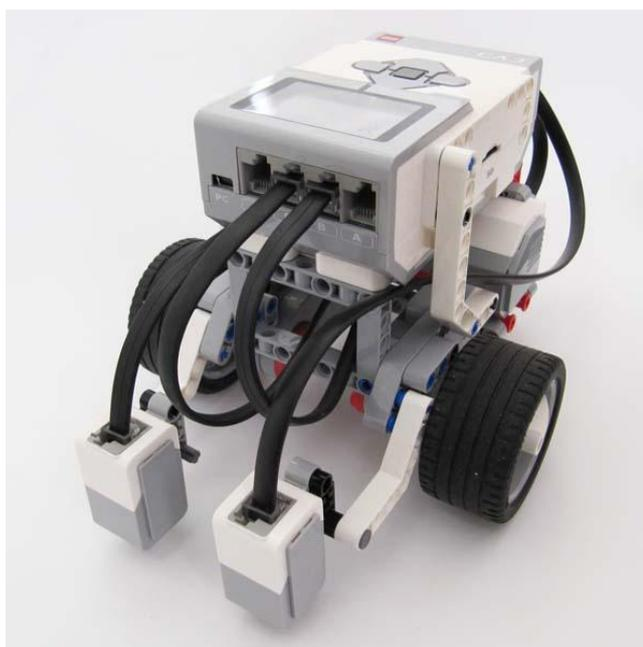
Рисунок 1.9 – Робот с двумя датчиками
