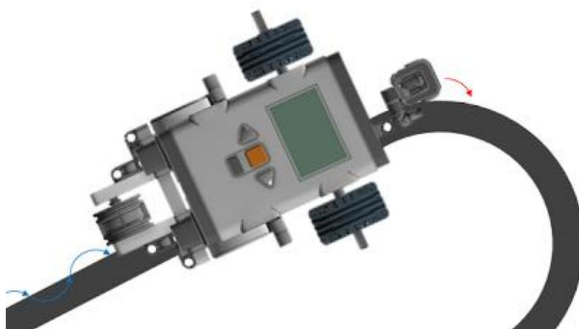
Рисунок 1.7 – Робот с одним датчиком на крутом повороте
