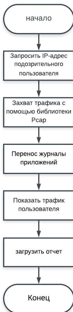
Рисунок 2.4 – Схема алгоритма анализа трафика в корпоративных приложениях
