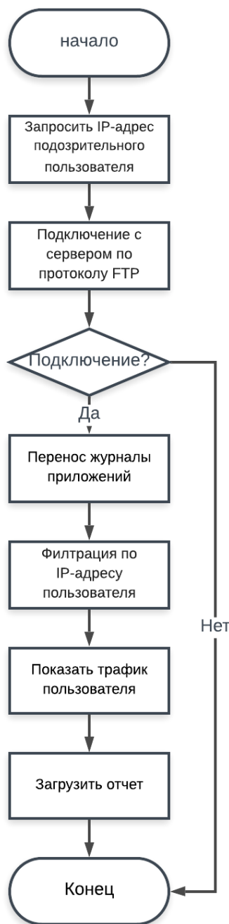
Рисунок 2.3 – Схема алгоритма подключения к серверу протоколу TSP
