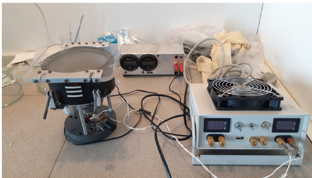
Рис. 3.3. Внешний вид спинкоутера, тахометра и генератора
