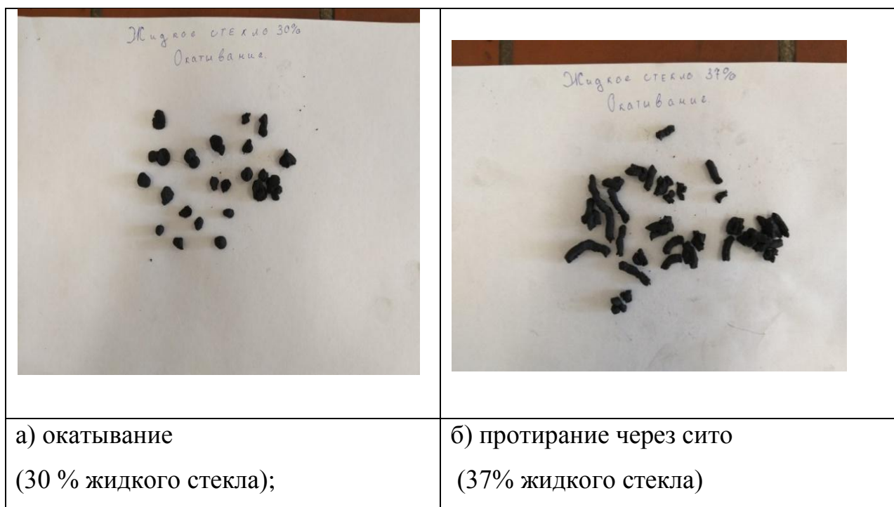
Рисунок 3.1 – Гранулы из циклонной пыли на жидком стекле:
