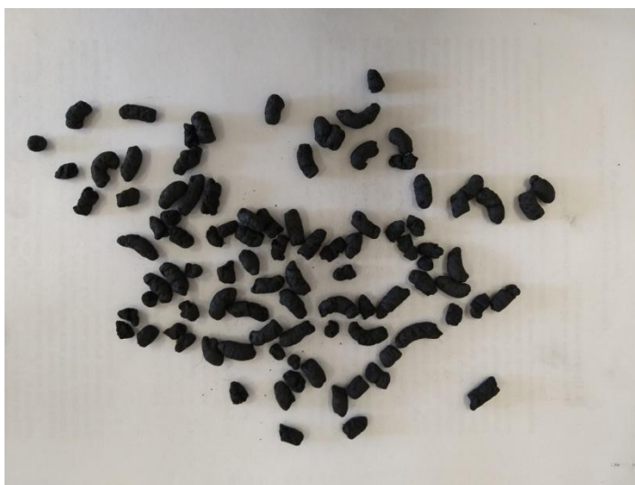
Рисунок 3.2 – Гранулы из циклонной пыли на жидком Bakellite
