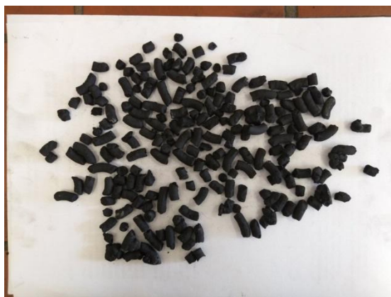
Рисунок 3.3 – Гранулы из циклонной пыли на Bakelite PF 6357 FP
