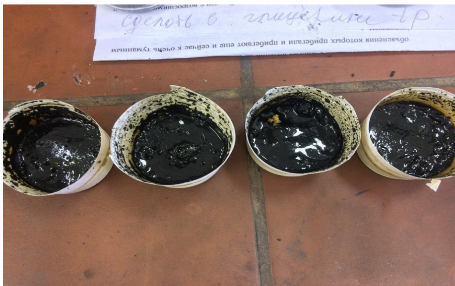
Рисунок 3.1 – Внешний вид образцов после сушки при 115°С
