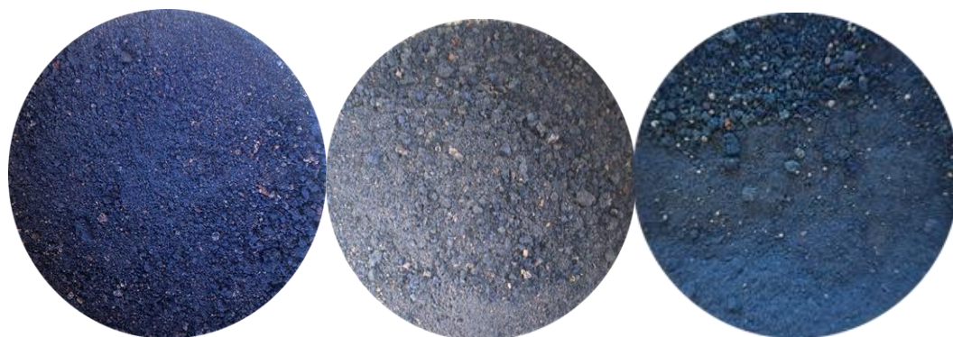
Рисунок 3.8 – Сравнение образцов при разном соотношении кислой смолки и отвердителя без ПАВ:
