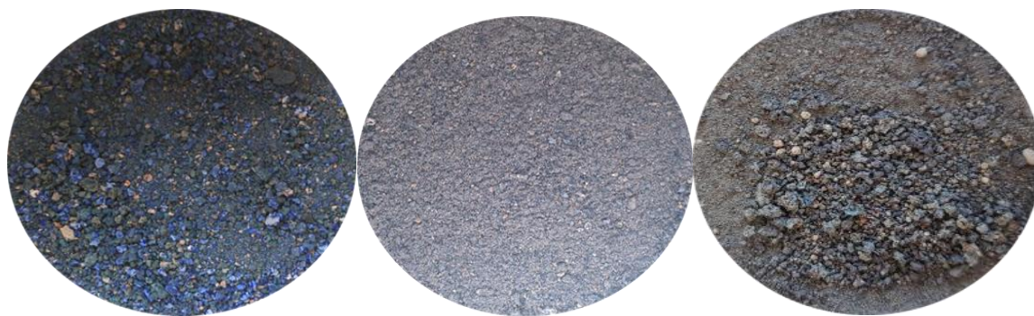
Рисунок 3.9 – Сравнение образцов при разном соотношении кислой смолки и отвердителя с ПАВ:
