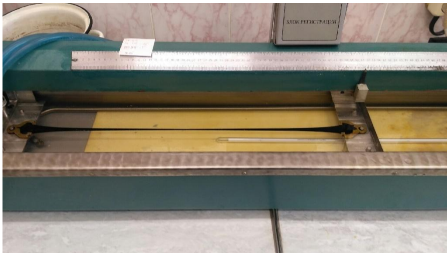
Рисунок 20–Проведение испытания на растяжимость образцов при 25°C
