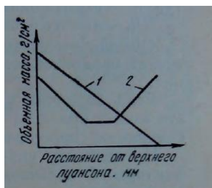
Рис. 1.7. Изменение плотности блока при одно- и двустороннем прессовании: 1 — одностороннее; 2 — двустороннее прессование.
