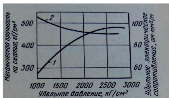
Рис. 1.8. Зависимость свойств обожженных материалов от давления при прессовании (20% нефтяного кокса и 80% сажи): 1 — механическая прочность; 2 — удельное электросопротивление
