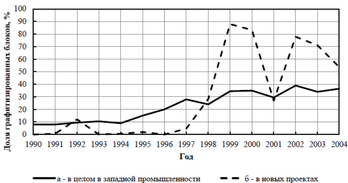
Рисунок 2 – Динамика использования графитизированных блоков: а – доля в западной промышленности, б – доля в новых проектах
