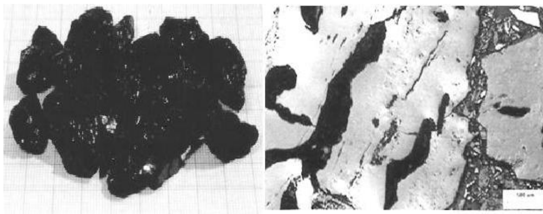
Рисунок 9 – Структура антрацита: а – антрацит с блесками и цилиндрическими поверхностями на изломе; б – антрацит с плоской невыраженной анизотропией
