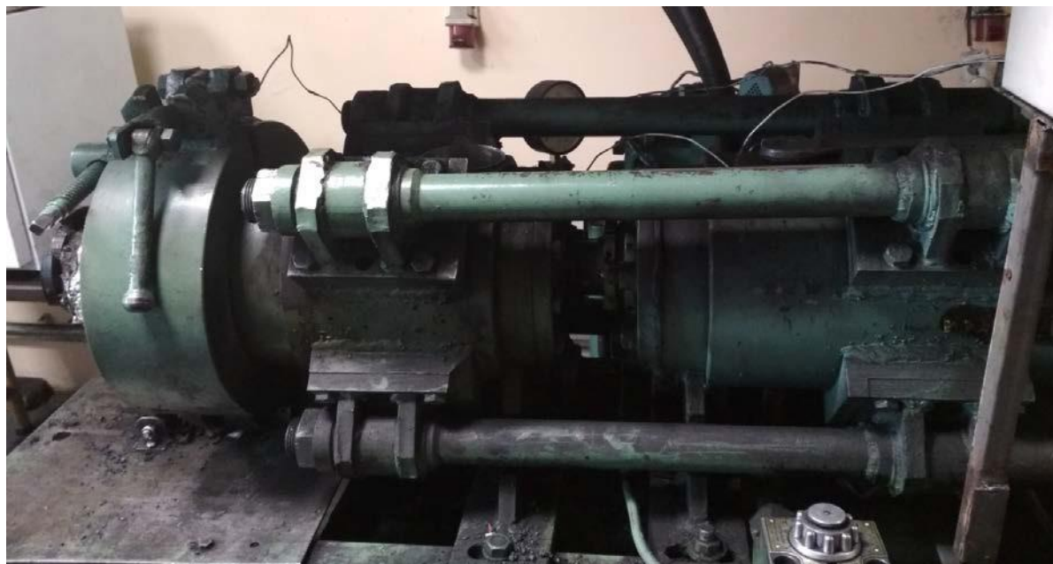
Рисунок 16 – Горизонтальный экструзионный лабораторный пресс
