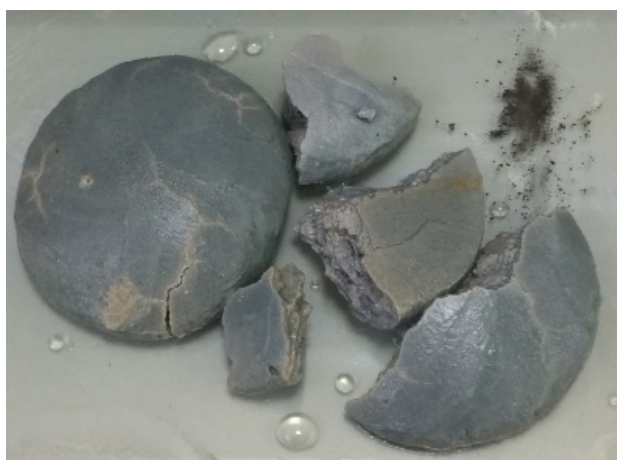
Рис. 3. Лепешки из шлака АКОС после испытания на равномерность изменения объема при твердении
