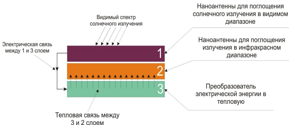
Рис. 5. Модель трехслойного приемника электромагнитного излучения [6]
