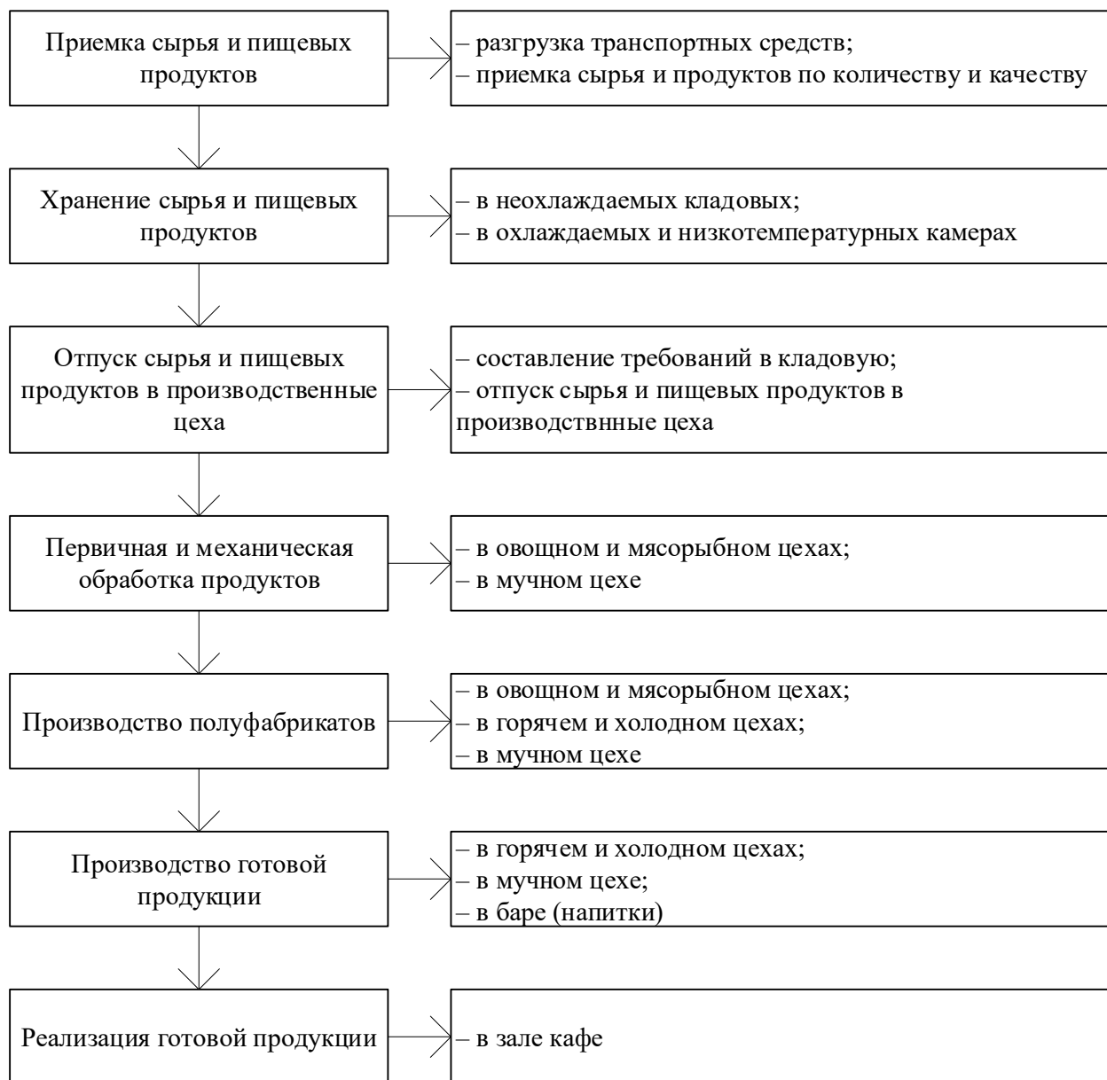
Рисунок 2.2 – Схема технологического процесса в кафе дагестанской кухни на 50 мест
