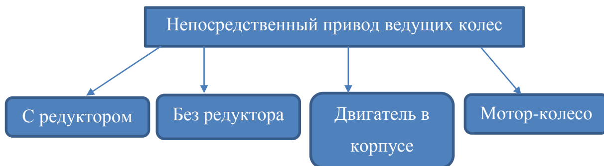
Рисунок 3.2 – Разновидности непосредственного привода ведущих колес
