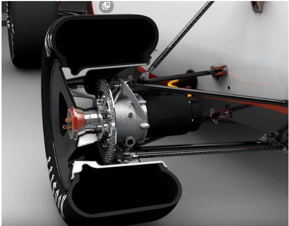
Рисунок 2.6 – Мотор-колесо электроболида Grimse
