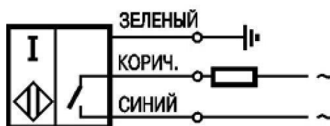
Рисунок 14.2 – Схема подключения нагрузки датчика ISN I7P-31P-25-LZ
