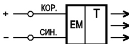
Рисунок 14.3 – Схема подключения оптического датчика (излучателя)
