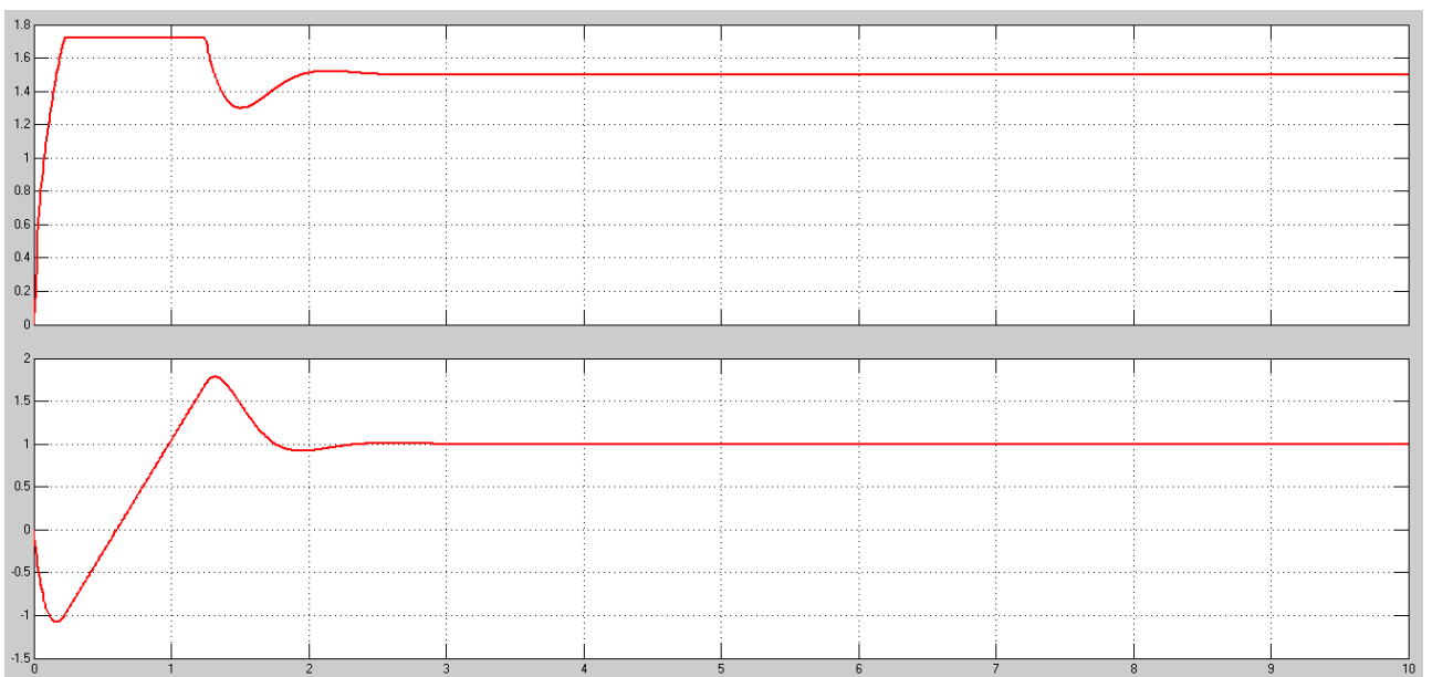
Рисунок 6.18 – Переходные процессы при набросе нагрузки M_c=1,5
