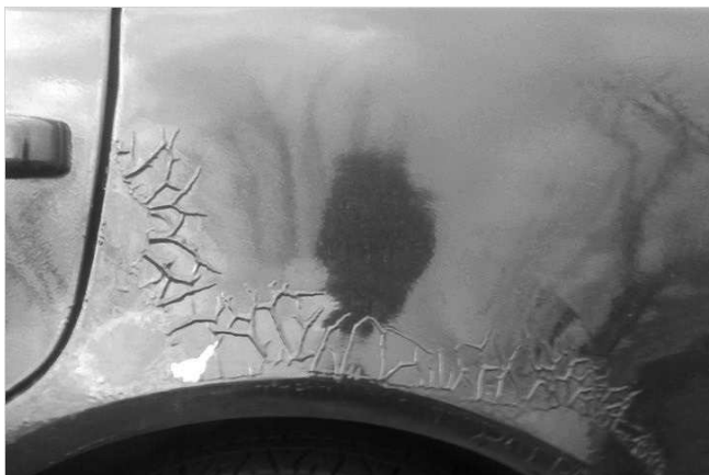
Рисунок 1 – Растрескивание твердой эмали
