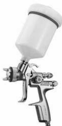
Рисунок 3.1 – Краскопульт с бачком 0,6 л сопло 1,8 мм Sata jet 1000 B RP
