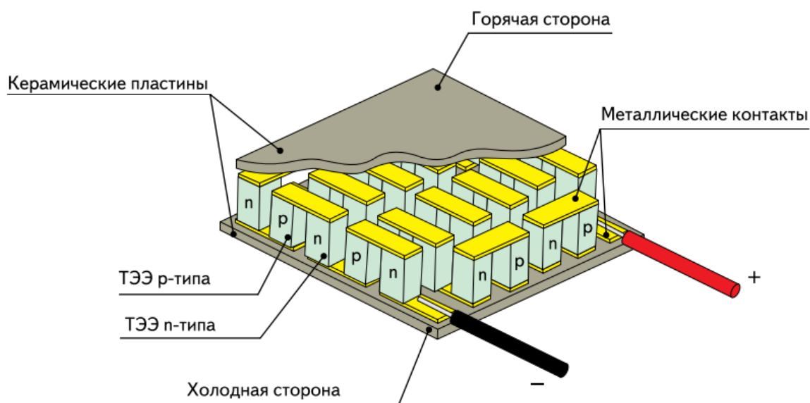
Рисунок 2.1 – Термоэлектрический модуль в разрезе
