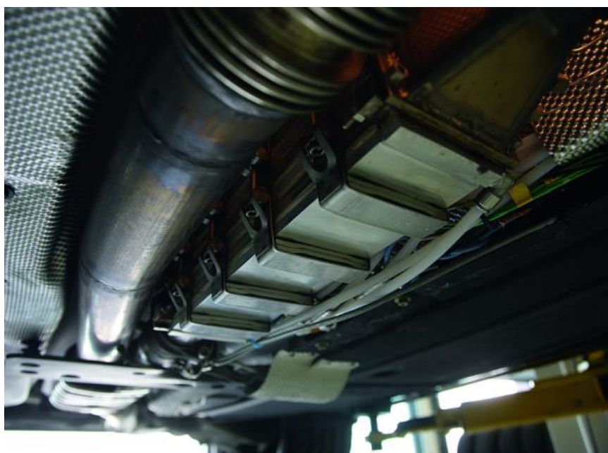
Рисунок 1.5 – ТЭГ установленный поверх модифицированной части глушителя
